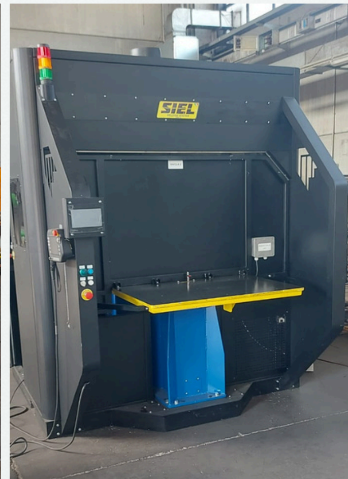
ISOLE COMPATTE DI SALDATURA CON ROBOT PANASONIC CON DOPPIA TAVOLA 1000 x 600 E DOPPIO TORNIO 1000 x 600
