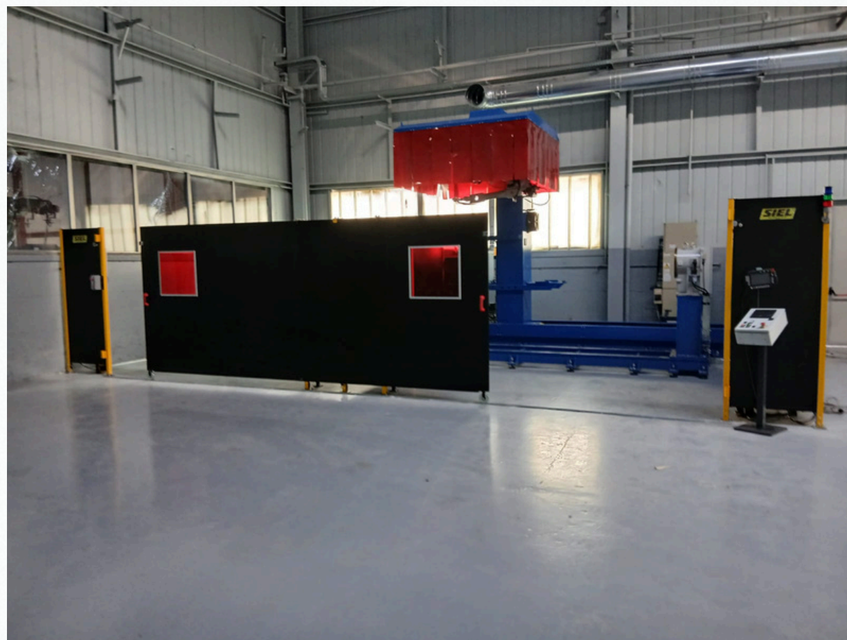
IMPIANTO DI SALDATURA CON ROBOT PANASONIC SU COLONNA CON SLITTA DI 12 METRI CHE ASSERVE 2 TORNII LUNGHEZZA 3000 x 2500 ROTABILE
