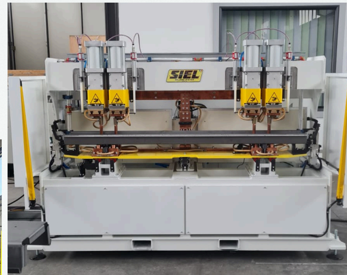
IMPIANTO SPECIALE DI SALDATURA A RESISTENZA IN MEDIA FREQUENZA CON 4 CILINDRI ED ASSE Y PER SALDATURA VITI A TENUTA STAGNA PER PARTICOLARE SEVEL
