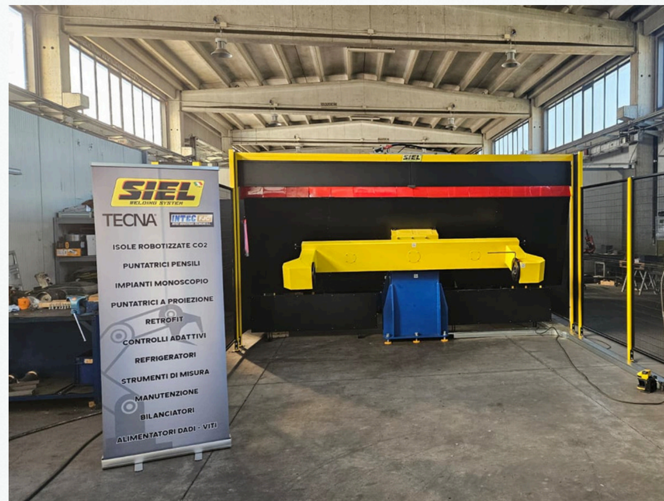
IMPIANTO SPECIALE DI SALDATURA A RESISTENZA IN MEDIA FREQUENZA CON 4 CILINDRI ED ASSE Y PER SALDATURA VITI A TENUTA STAGNA PER PARTICOLARE SEVEL
