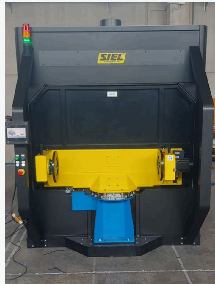
ISOLE COMPATTE DI SALDATURA CON ROBOT PANASONIC CON DOPPIA TAVOLA 1000 x 600 E DOPPIO TORNIO 1000 x 600
